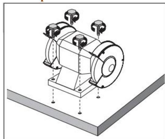
Установите изделие на ровную твердую поверхность и закрепите с помощью крепежных изделий (не входят в комплект) через отверстия.
